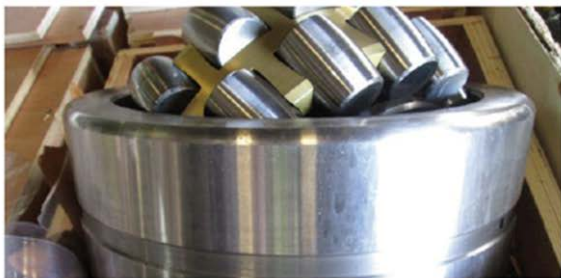
这是假冒轴承吗？是的。注意点：无吊孔，倒角处不应打磨，滚子端面无凹槽。
